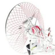
Châssis carbone haute performance (pré-imprégné - autoclave)
